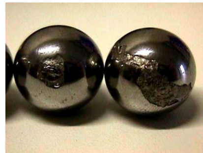
Şekil 32. Değiştirilen rulmandan Çıkan hasarlı bilyalar
