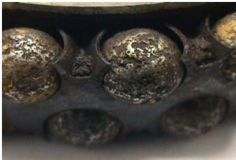
Şekil 48. Çıkan rulmanın durumu
