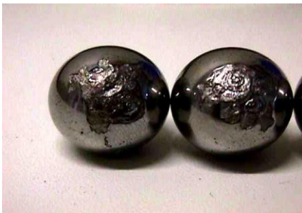
Şekil 32. Değiştirilen rulmandan Çıkan hasarlı bilyalar
